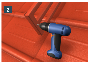
2 UKONČOVACÍ PROFIL ZAFIXUJTE ŠROUBEM, KTERÝ JE SOUČÁSTÍ DODÁVKY
