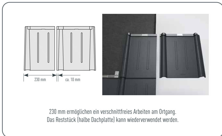
Abbildung 11 • Dachplatte – Schnürung
