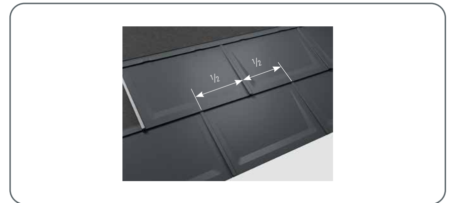
Abbildung 20 • Dachplatte R.16 – Verlegung
